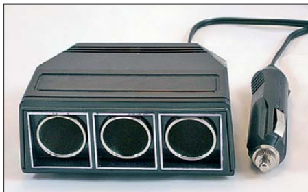
Bild 4: Verteilerstecker mit dünnen und langen Kabeln sind brandgefährlich, da die Sicherungen bei hohen Leitungswiderständen nicht mehr auslösen. Der hier gezeigte Mehrfachstecker hat bereits einen Innenwiderstand von knapp 0,2 \Omega .
