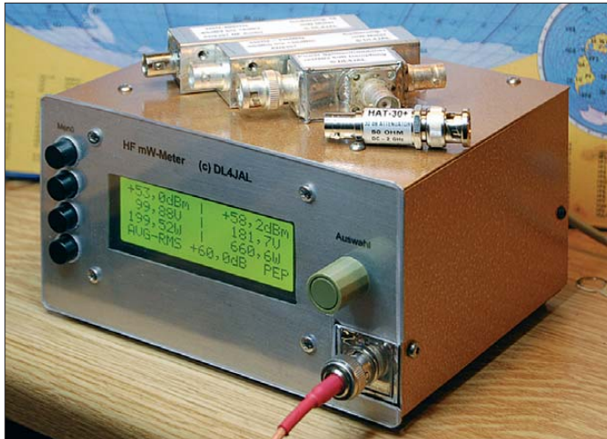
Bild 1: Prototyp des HF-Milliwattmeters mit zwei Wechselmessköpfen, einem Combiner mit Widerständen zur Messsignalverzweigung und einem 30-dB-Dämpfungsglied zur Kalibrierung; in der Anzeige ist das Messergebnis eines Zweitonsignals zu sehen. Vorgeschaltet sind 60 dB Leistungsdämpfung.
