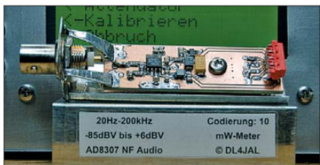
Bild 8: NF-/Audio-Messkopf mit AD8307; hier wurde die Codierung der Messkopfnummer mit Null-Ohm-Widerständen realisiert.
