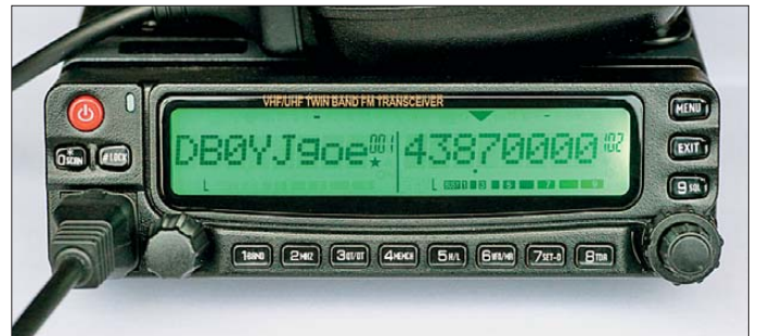
Bild 6: Im Einstellmenü sind für jeden Betriebszustand verschiedene Displayfarben definierbar, darunter Grün beim Empfang.
