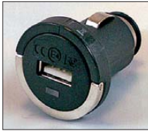
Bild 5 (links): Für den Anschluss von 5-V-Kleinverbrauchern eignen sich gut im Zigarettenanzünder einsteckbare Spannungswandler. Es gibt sie mit bis zu vier Ausgängen, wobei die entnehmbare Stromstärke auf je 1 A begrenzt sein sollte.
