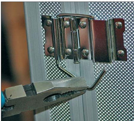
Bild 8: Entfernen der Deckelsicherung
