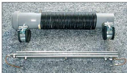
Bild 2: Aufbau eines Sperrkreises mit vergrößertem Kondensator Fotos: DK6ED
