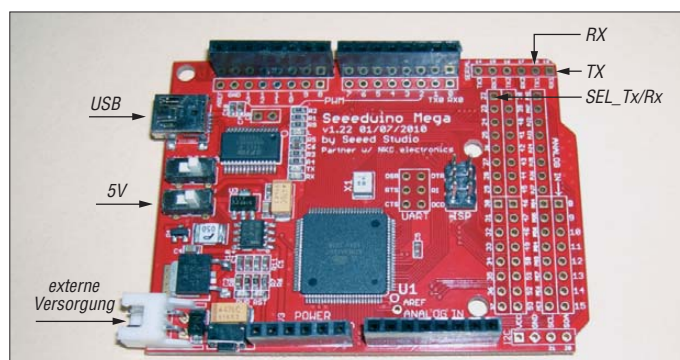
Bild 4: Das Seeeduino Mega Modul basiert auf dem ATmega1280 . Der Schalter für die Höhe der Betriebsspannung ist auf 5 V einzustellen. Fotos und Screenshots: Sander
