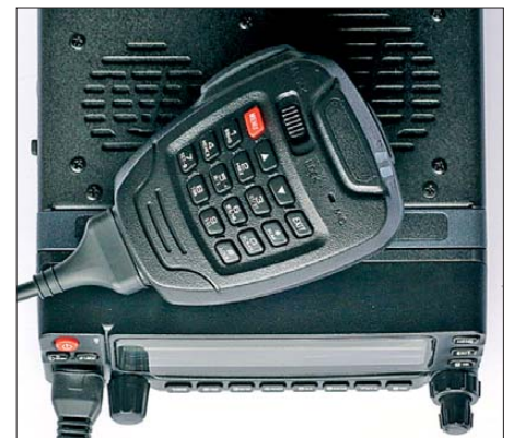
Bild 2: Das große DTMF-Mikrofon erleichtert die Bedienung. Dank Hintergrundbeleuchtung ist dessen Beschriftung auch im Dunkeln ablesbar.
