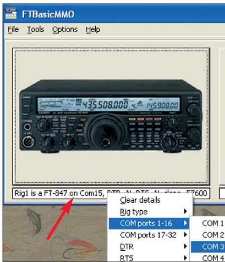
Bild 3: Zum Einstellen des COM-Ports muss man bei FTBasicMMO mit der rechten Maustaste in die Zeile unter dem Gerät klicken.
