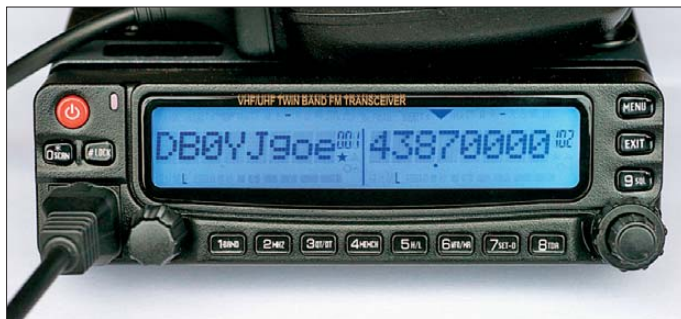
Bild 1: Der Twinbänder Maas AMT-920-UV zeigt auf seinem Display Frequenzen oder Kennungen zweier verschiedener Kanäle (hier links: Rufzeichen des 2-m-Relais DB0YJ; rechts: Frequenz des örtlichen 70-cm-Relais).
