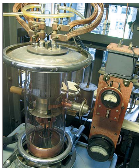
Wassergekühlte CAT14-Sendetriode für eine Anodenspannung von 20000 V des 150-kW-LW-Senders
