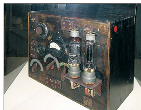
Der wahrscheinlich erste schwedische Rundfunksender, aus Liebhaberei von Gustav Holm erbaut, war von 1922 bis 1924 in Karlstad in Betrieb.
