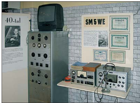
Amateurfunkstation von SM5WE, erbaut Ende der 1950er-Jahre für SSB, CW und AM
