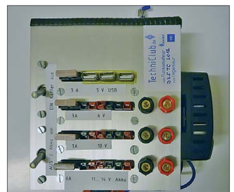
Bild 6: Anschlussfeld mit Schaltern
