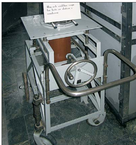
Höhenverstellbarer Wagen zum Austausch der Senderöhre CAT14
